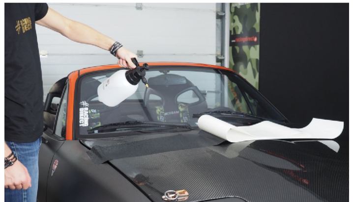
Usuń papier podkładowy z połowy pasa. Obficie zmocz klejącą stronę naklejki. Używaj wyłącznie czystej wody BEZ MYDŁA I DETERGENTÓW .
